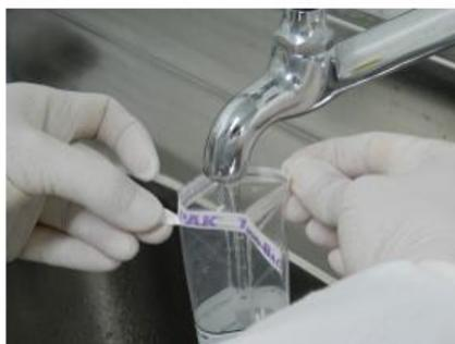
f) coletar a amostra, evitando tocar as paredes laterais da bolsa de coleta nas bordas da torneira;
