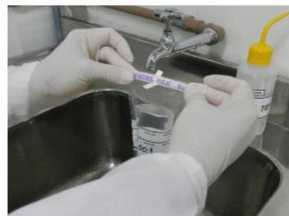
g) coletar um volume de amostra até o final da tarja branca de identificação e pressionar as laterais a bolsa de coleta;
