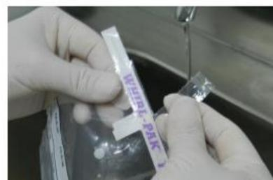
d) abrir a torneira, deixando a água escoar por cerca de 2 a 3 minutos. Ajustar a abertura da torneira em fluxo baixo de água. Destacar a parte superior por meio do picote;
