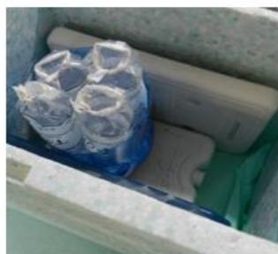
k) acondicionar adequadamente as amostras na caixa térmica com gelo reciclável. Não deixar o gelo em contato direto com a bolsa de coleta contendo a amostra.
