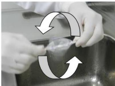
i) girar a bolsa de coleta sobre ela mesma, até que fique bem rígido (duas a quatro voltas);
