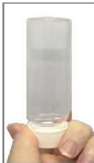
Figura 2 - Verificação da ausência de bolhas
