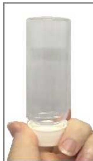
Figura 2 - Verificação da ausência de bolhas
