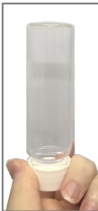
Figura 2 – Verificação da ausência de bolhas
